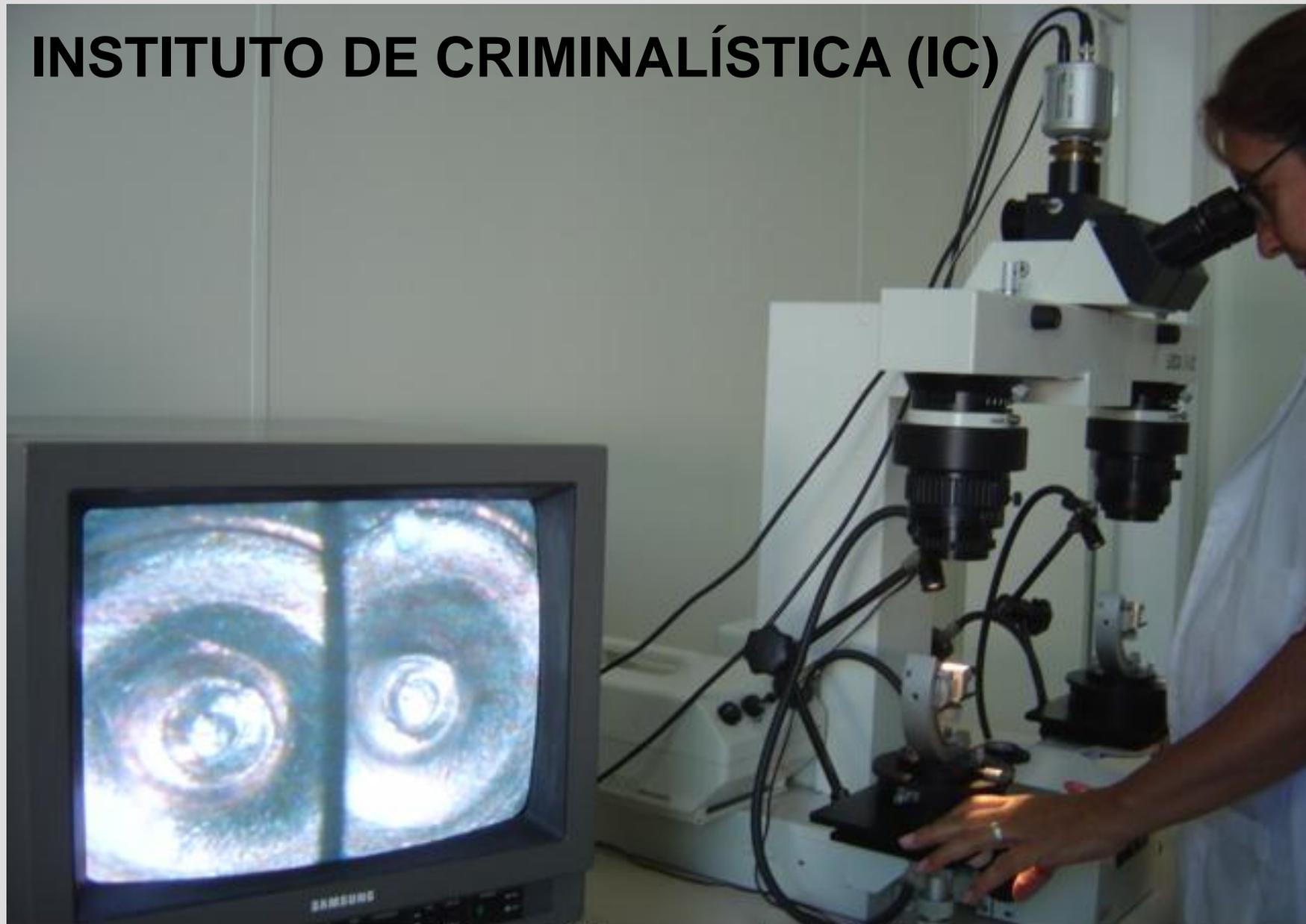
**Microscópio comparador balístico**
