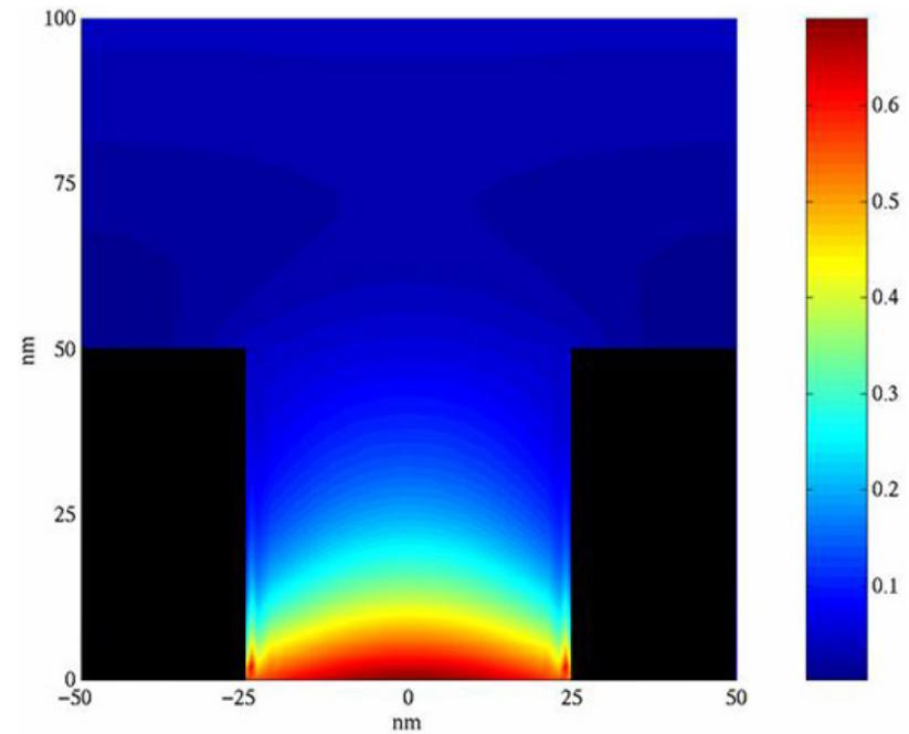
Sinal fluorescente é detectado de uma janela com interferência mínima de luz
