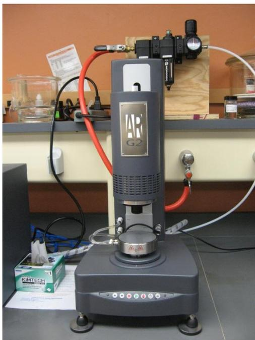
**Figura 7.** Equipamento utilizado para medir a viscosidade da amostra.
