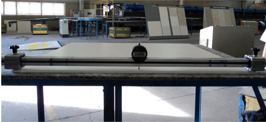
**Figura 2** – Medição de curvatura lateral de uma peça de porcelanato técnico na fábrica PB 10
