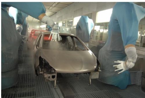
Figure 5– Cabines de peinture.
