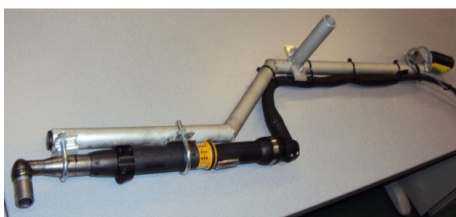
Figure 14 –.Moyen pour visser de loin au siège arrière.
