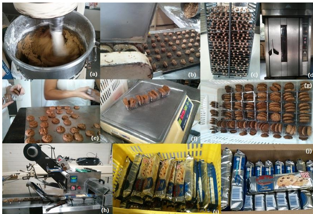
Figura 8 – Etapas do processo de fabricação do cookies com gotas de chocolate, (a) mistura de ingredientes para formação da massa, (b) conformação dos biscoitos, (c) carrinho de bandejas, (d) forno, (e) acondicionamento em formas plásticas, (f) pesagem das formas, (g) acondicionamento em caixas plásticas, (h) equipamento de fechamento dos pacotes, (i) produto e (j) encaixotamento.
