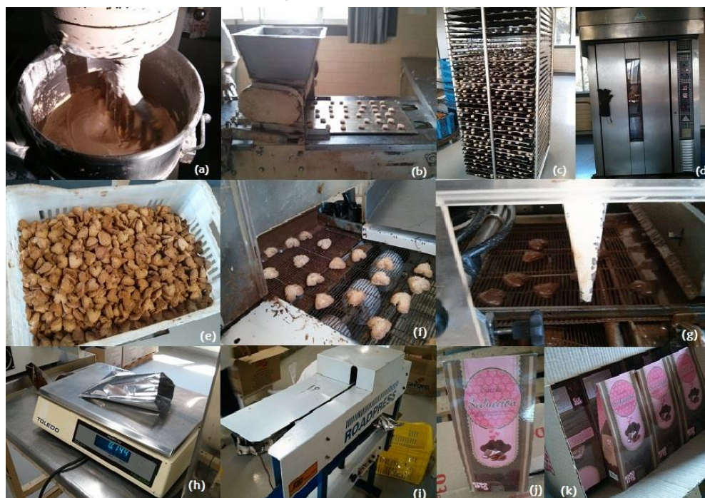
Figura 4 – Etapas do processo de fabricação do biscoito Seducção , (a) mistura de ingredientes para formação da massa, (b) conformação dos biscoitos, (c) carrinho de bandejas, (d) forno, (e) acondicionamento em caixas plásticas, (f) cobertura, (g) cobertura, (h) balança para fechamento dos pacotes, (i) selamento dos pacotes, (j) embalagem e (k) encaixotamento.
