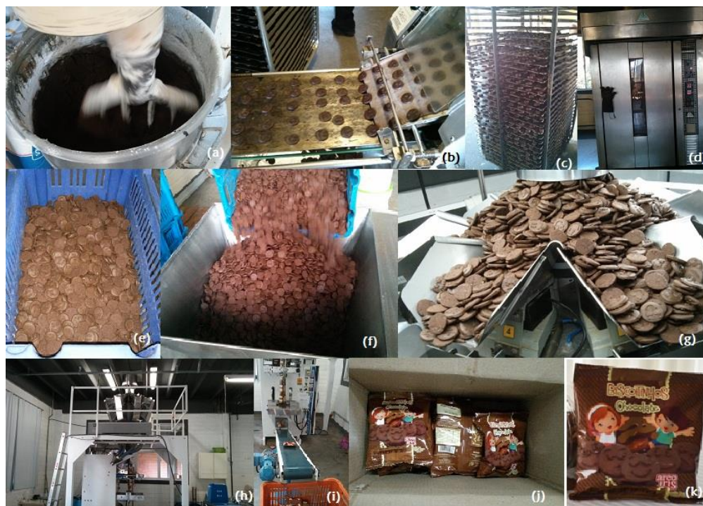
Figura 8 – Etapas do processo de fabricação do cookies com gotas de chocolate, (a) mistura de ingredientes para formação da massa, (b) conformação dos biscoitos, (c) carrinho de bandejas, (d) forno, (e) acondicionamento em formas plásticas, (f) pesagem das formas, (g) acondicionamento em caixas plásticas, (h) equipamento de fechamento dos pacotes, (i) produto e (j) encaixotamento.
