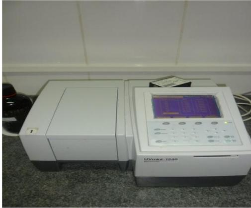
**Figura: Espectrofotômetro UV usado na determinação de cor, amargor e diacetilo de cerveja.**
