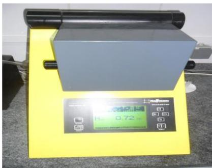
**Figura: Turbilímetro Haffmans** Fonte: CAVIBEL
