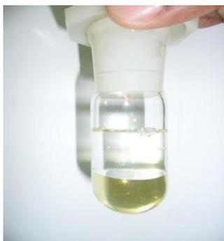
**Figura: Amostra para determinação de amargor (fase superior - isoctano).**
