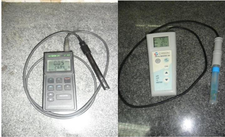
Figura 1: Medidor de pH (esquerda) e medidor de condutividade (direita).
