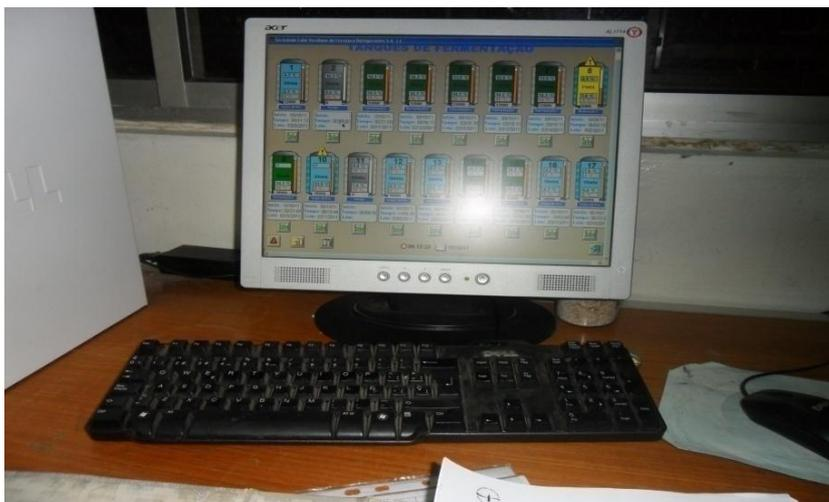
**Figura: Computador para controlo de temperatura de fermentação.**
