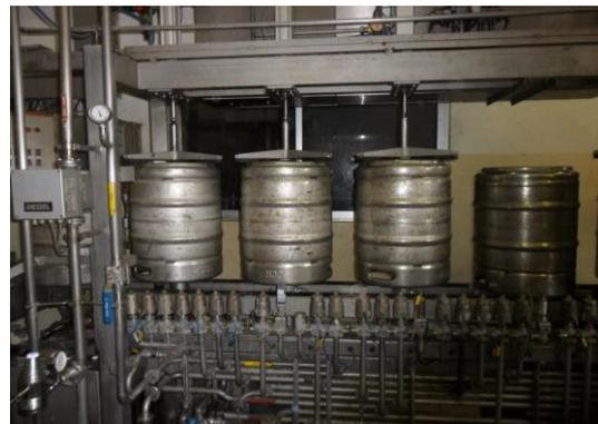
**Figura:** Enchedora e encapsuladora de garrafas. **Figura:** Enchedora de barris.
