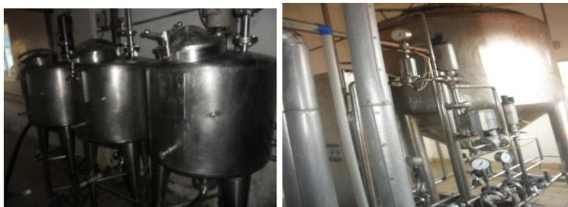
Figura: A esquerda estão três “levourier” (pequenos tanques usados na transferência de levedura) e a direita um propagador de levedura.
