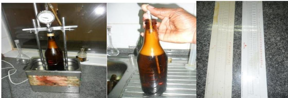
**Fig:** Banho ultrassónico acoplado a um medidor de pressão (figura da esquerda) e medição de temperatura (figura da direita) para determinação de CO<sub>2</sub>.
