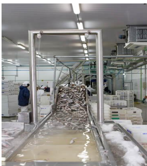
Figura 10 - Processo de glaciamento contínuo.
