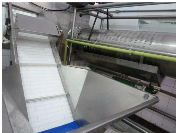
Figura 5 - Tanque de aço inox para separação do gelo.
