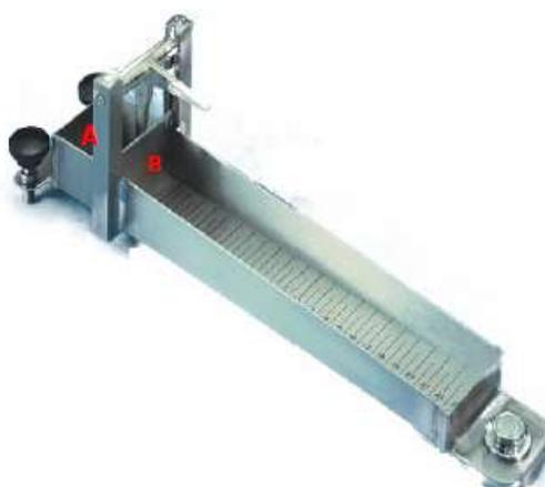
Figura 4 - Consistômetro de Bostwick
