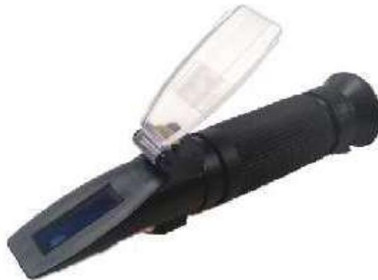
Figura 2 – Refratômetro para medição de sólidos solúveis
