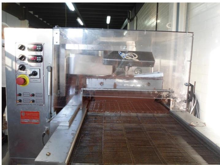
**Figura 1:** Parte de aquecimento de uma das cobrideiras da fábrica.
