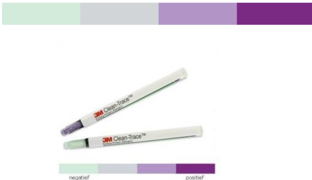
Figura 2- Teste 3M, swab com reação para formação de cor.
